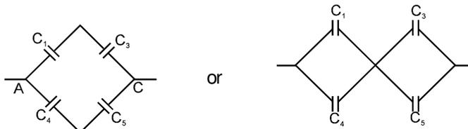
(v)  $C_{eq} = \frac{(C_1 + C_4)(C_3 + C_5)}{C_1 + C_2 + C_3 + C_5}$
